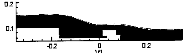
圖 5 LSFEM 模擬之洪流自由水面流線
