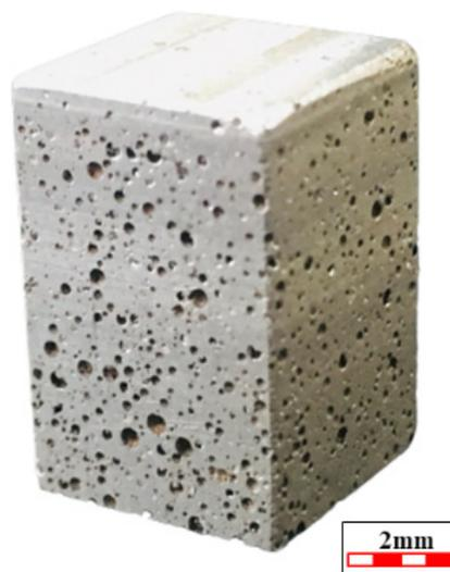
圖 2 40% 孔隙率之 17-4PH 泡沫鋼
