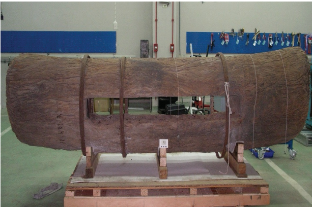
圖 3. 該車膛長 385 公分、直徑 75 公分之木質圓柱體，外有 3 道鐵圈，內部含鐵框架之中空結構。
