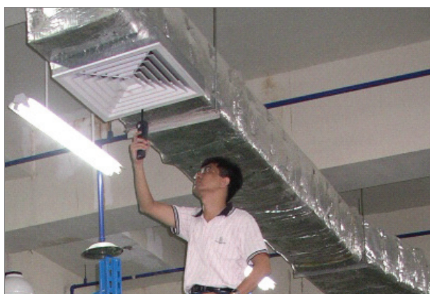
圖 6. 量測風管出風口風速
