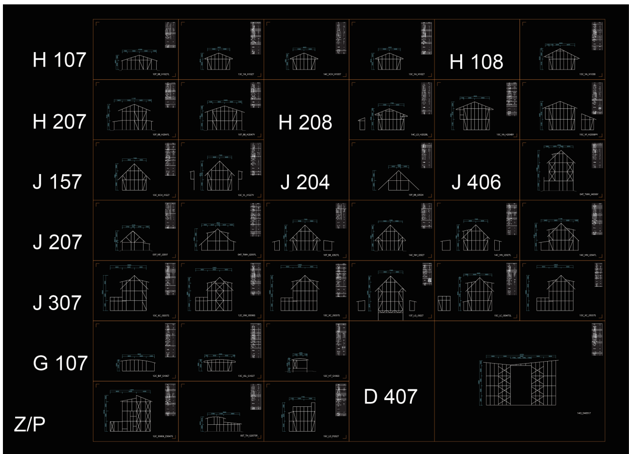
圖1：常民單線圖圖庫(局部)：彙整歷年曾經作過的案子，一個案子以單線屋架圖加上表格內的資訊做為代表，一條單線代表著特定的構件中心線。代號是以屋頂的型式、層高、柱子數量組合而成，例如：J208代表尖屋頂、兩層樓、8柱。
