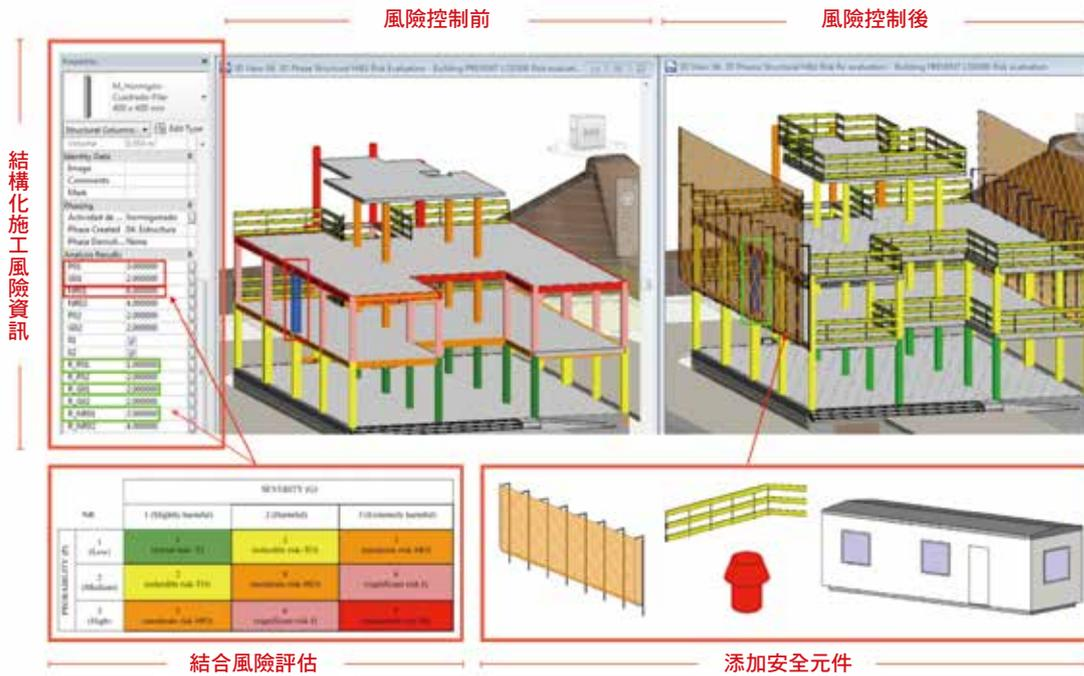
圖 9 營造工程施工安全 BIM 應用發展方向 [6]
