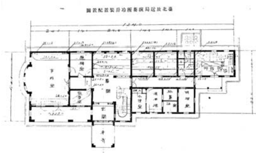
圖 12 臺北放送局二樓冷房裝置配置圖 （採自〈臺灣建築會誌〉第 3 輯第 3 號）
