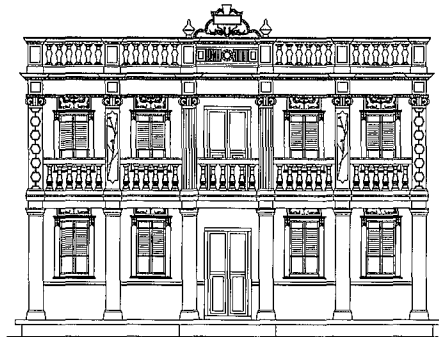
圖 12 一、二樓不同柱頭的作法
