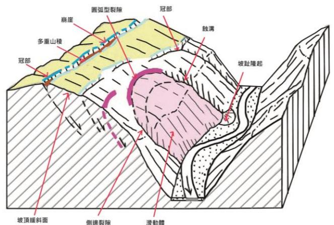
圖 4 大規模崩塌細微地形特徵示意圖(修改自鈴木隆介, 2000)
