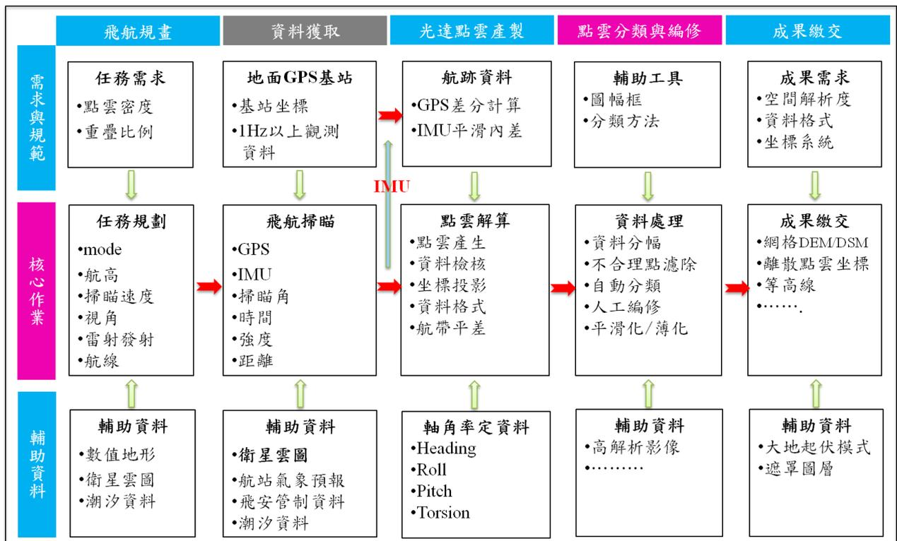
圖 3 空載光達作業流程圖
