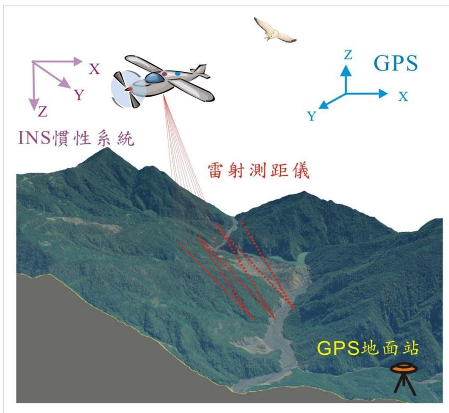
圖 2 空載光達掃瞄示意圖(謝有忠等, 2012)
