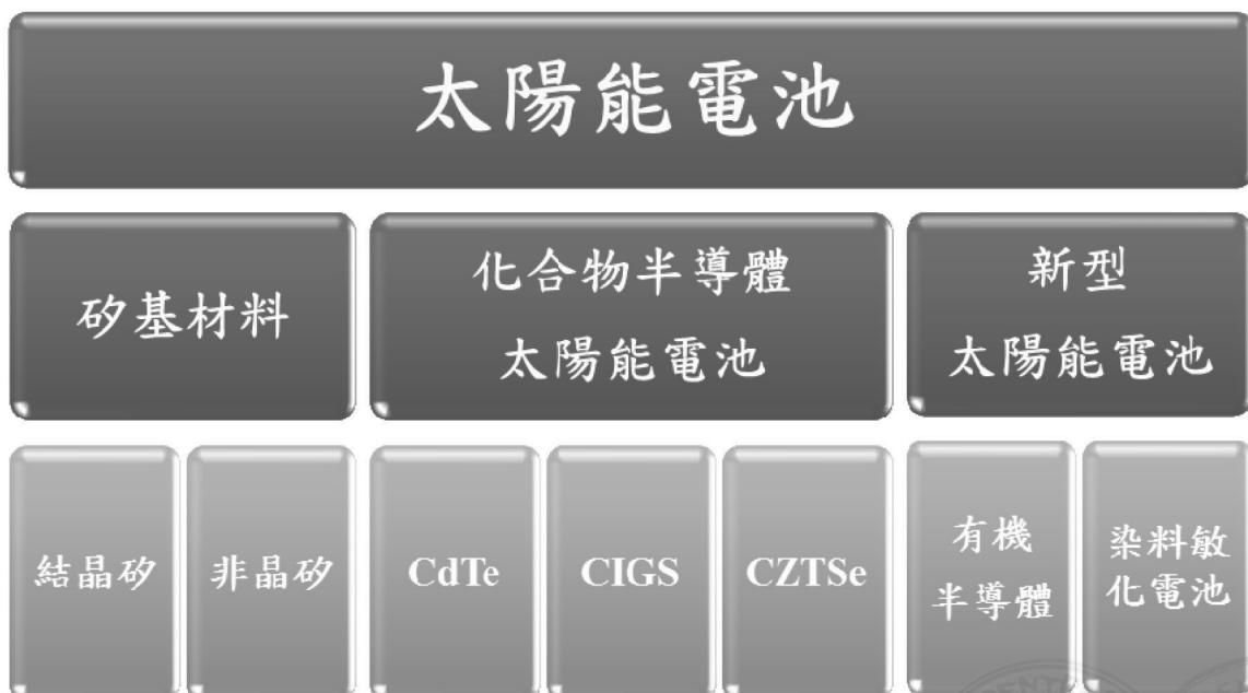
圖 1 太陽能電池材料種類
