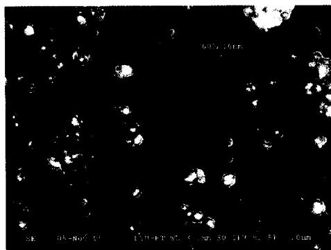
圖 12. 奈米碳管 SEM (成長溫度 900°C)
